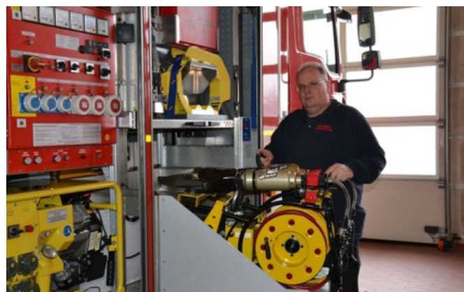
Viel Zeit nimmt vor allem die Prüfung der hydraulischen Gerätschaften in Anspruch, wie hier die Überprüfung der Rettungsschere und des Spreizers beim Rüstwagen.
